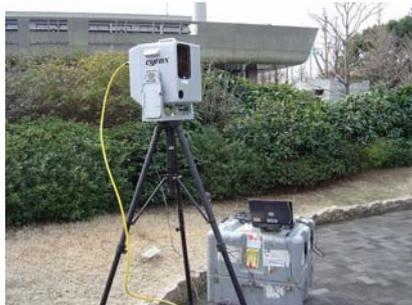
図6 レーザレンジセンサー
